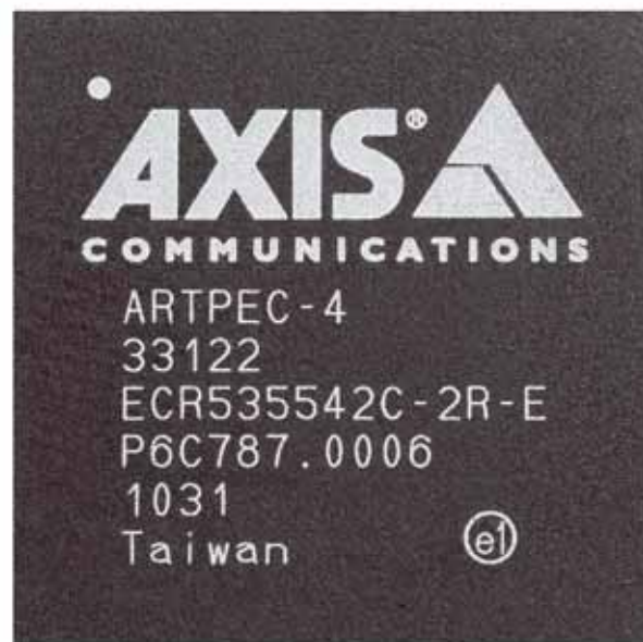
AXIS ARTPEC-4 chip, designet for nettverkskamera
